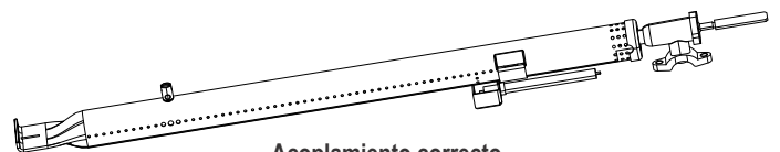
Acoplamiento correcto del quemador con la válvula
