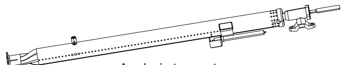
Acoplamiento correcto del quemador con la válvula
