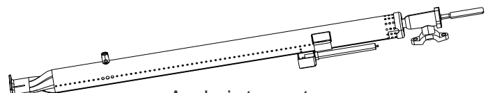
Acoplamiento correcto del quemador con la válvula
