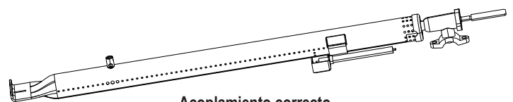
Acoplamiento correcto del quemador con la válvula
