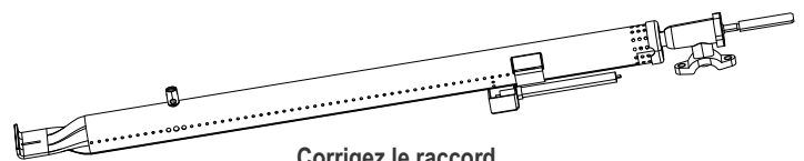
Corrigez le raccord brûleur-à-valve.
