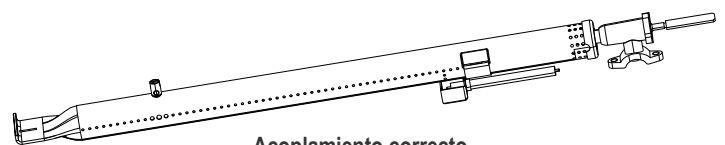
Acoplamiento correcto del quemador con la válvula
