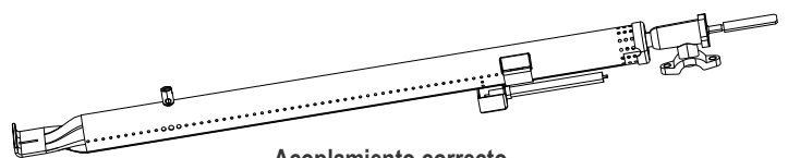
Acoplamiento correcto del quemador con la válvula
