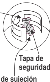
Válvula del tanque de gas
